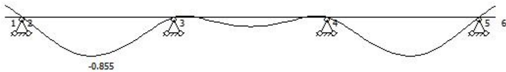
图 14.13 主梁变形图二(mm)
